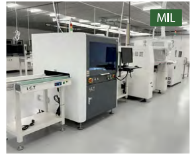
Dây chuyền gia công mạch SMT
